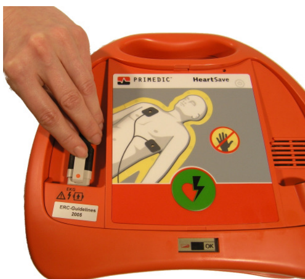
Rys. 12: Podłączanie wtyków elektrod
