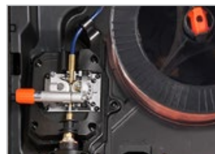
Modele Kempact 181/251 posiadają 2-rolkowy mechanizm podający GT02C.
