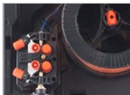
Modele Kempact 253/323 posiadają 4-rolkowy mechanizm podający DuraTorque.
