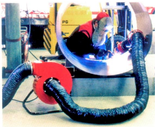
Wentylator przenośny współpracujący ze ssawką magnetyczną podczas spawania
