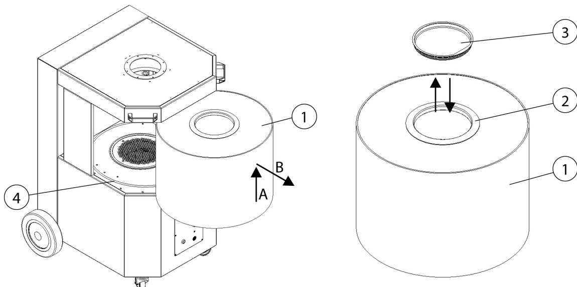
Obr. 54: Výměna filtru – Vyjmutí filtrační vložky
