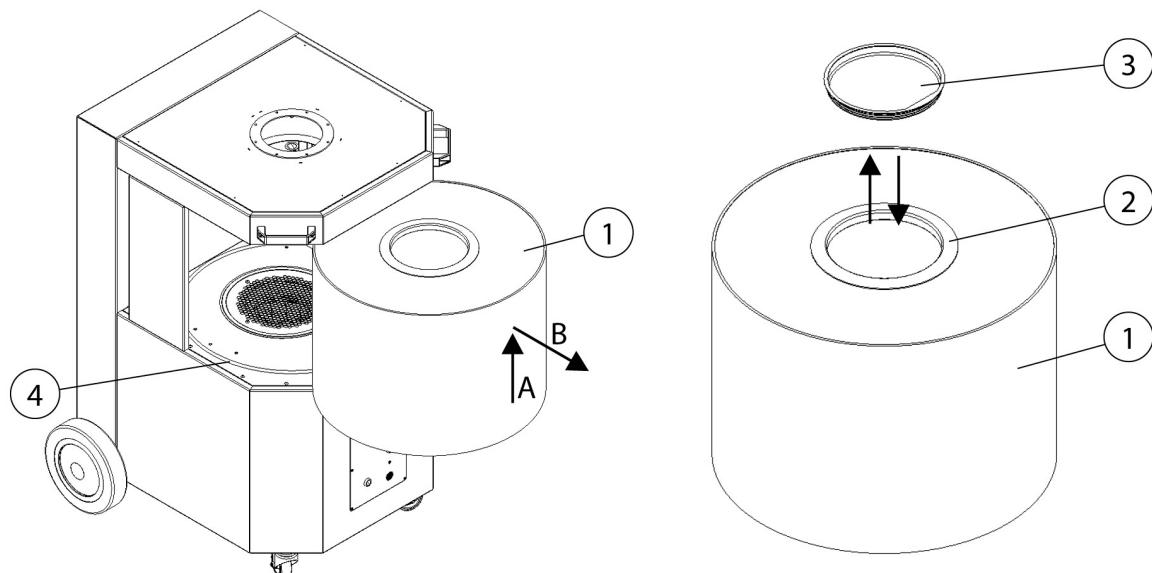
*Fig. 33: Cambio del filtro - Extraer el elemento filtrante*
