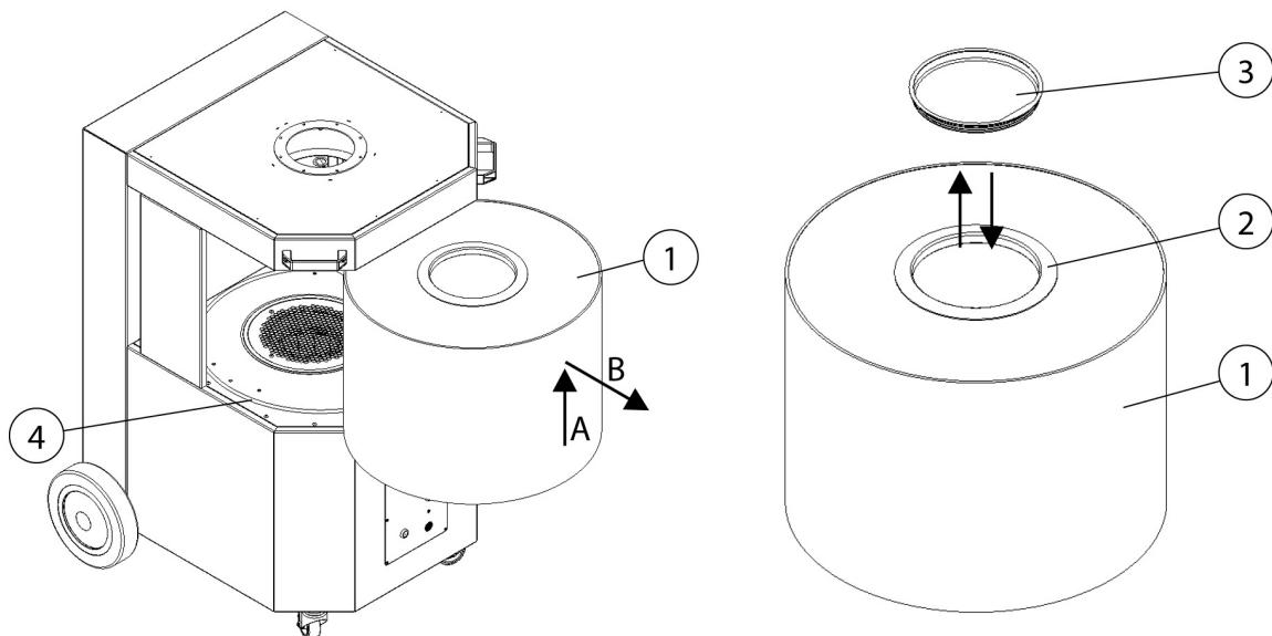
Рис. 68: Замена фильтра - извлечение фильтрующего элемента
