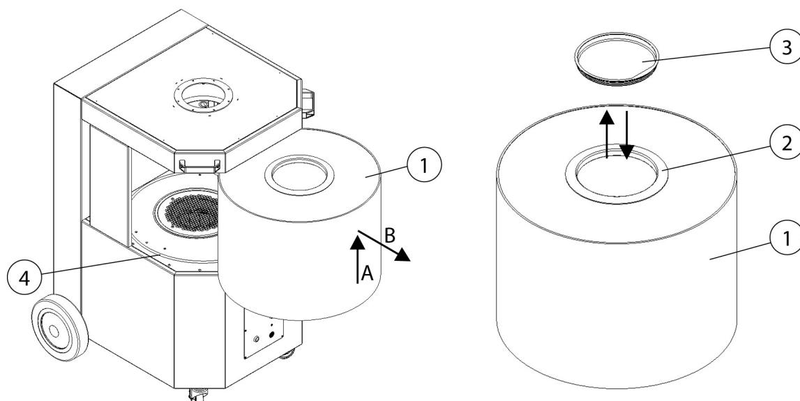
Rys. 61: Wymiana filtrów – Wyjmowanie elementu filtrującego
