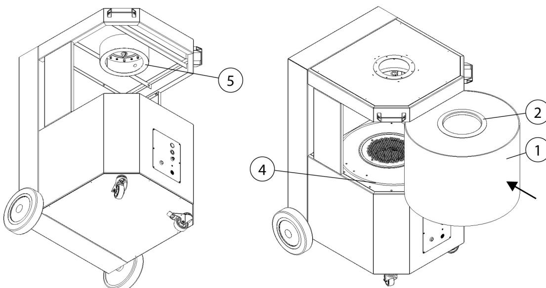
Rys. 62: Wymiana filtrów - Wkładanie elementu filtrującego
