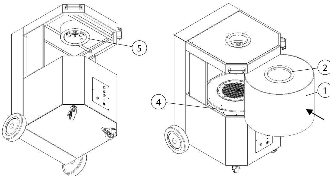
Obr. 55: Výměna filtru – Vložení filtrační vložky
