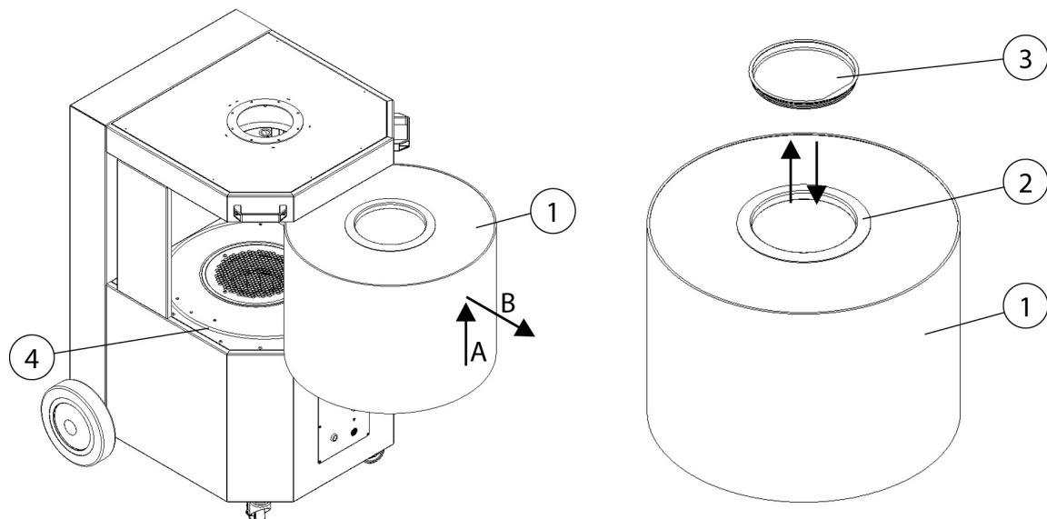
Abb. 5: Filterwechsel – Filterelement entnehmen
