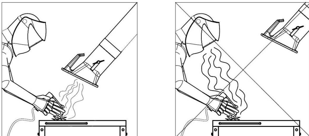
Fig. 32: Posicionamiento de la campana de aspiración
