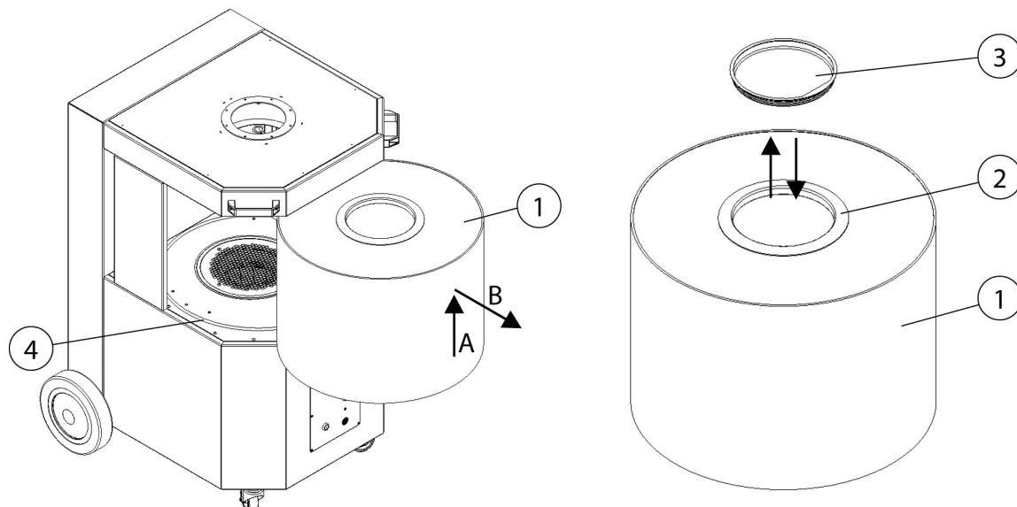
*Fig. 47: Cambio filtro - Rimuovere l'elemento filtrante*
