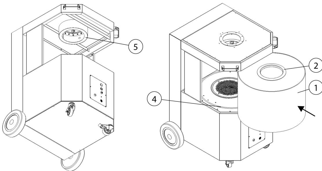
Рис. 69: Замена фильтра - установка фильтрующего элемента
