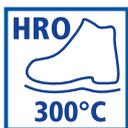
Schuhe mit temperaturbeständiger Laufsohle bis +300 ° C (kurzfristig) nach EN ISO 20345 und der Zusatzanforderung HRO (HRO = heat resistant outsole).
