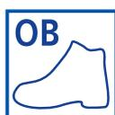
Berufsschuhe nach EN ISO 20347 OB ohne Anforderung an den Zehenschutz und an die Durchtrittssicherheit, bei denen alle Grundanforderungen erfüllt werden. Mindestens eine der Zusatzanforderungen Antistatik, geschlossener Fersenbereich oder Fersendämpfung wird nicht erfüllt.
