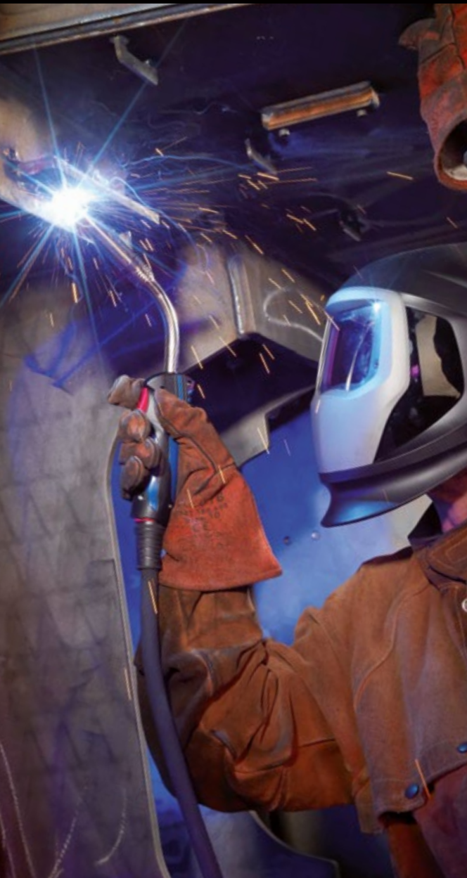
MB EVO PRO 36 w pozycji spawania PA (poziome spawanie spoin czołowych i pachwinowych).
