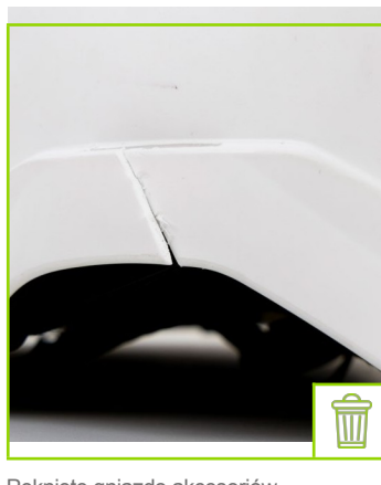
Pęknięte gniazdo akcesoriów
