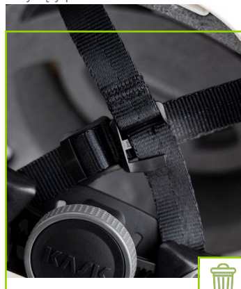
Uszkodzona tylna klamra regulacyjna
