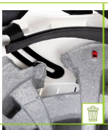
Brakująca część powłoki wewnętrznej
