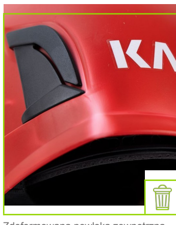
Zdeformowana powłoka zewnętrzna
