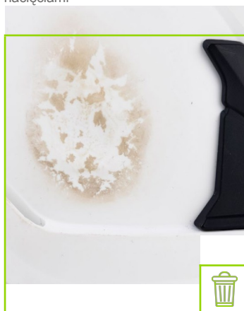
Powłoka zewnętrzna ze śladami substancji chemicznej
