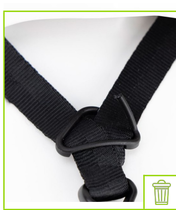
Uszkodzony rozdzielnik boczny
